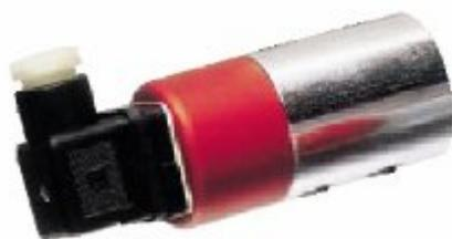
Il trasmettitore di pressione differenziale 692 è adatto per l'utilizzo con aria, gas non corrosivi, vapore a bassa pressione, acqua calda (con guarnizione FPM), freon e ammoniaca con guarnizione CR.
