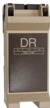
DR è un modulo ausiliario e viene impiegato come selettore di segnali da 2 a 10V. Al modulo DR vengono connessi due segnali in ingresso. Il segnale in uscita risultante può essere il più alto o il più basso a seconda della funzione richiesta: limite di massima o limite di minima. Il modulo DR funziona senza alimentazione. L'ingombro del modulo equivale ad una unità.
