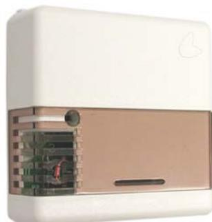
EGRLL è una sonda temperatura da ambiente a doppio termistore studiata per utilizzo in aree asciutte ed arieggiate, concepita per il montaggio a parete o per il montaggio su una scatola da derivazione di diametro 70mm. Può essere utilizzata per realizzare il valore di temperatura media ambiente rilevata da due termistori diversi. Adatta per esecuzione da ambiente, è completa di contenitore e soletta in policarbonato autoestinguente per montaggio diretto su pareti.
