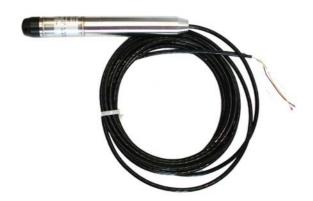
La sonda EGWW è studiata per il montaggio sulla tubazione senza l'utilizzo di altri elementi. L'elemento che viene immerso nella tubazione è di rame (CU) o di acciaio resistente agli acidi (ST). EGWW contiene due termistori, uno per funzioni di regolazione l'altro per controllo.ll sensore ha un raccordo di collegamento per l'installazione maschio DN15 (1/2"). Installazione elettrica: Ø 19 foratura per ingresso cavo e conduttori.
