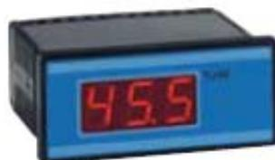
Visualizzazione dell'umidità relativa trsdotta da trasmettitori di umidità con uscita in corrente (4...20 mA a 2 o 3 fili). I trasmettitori possono essere alimentati direttamente dall'apparecchio se ammettono una tensione da 13.5 a 25 Vcc non regolata. Gestione di allarmi di tipo ottico (display lampeggiante e visualizzazione di codici di errore) in caso di trasmettitore aperto o in corto circuito.
