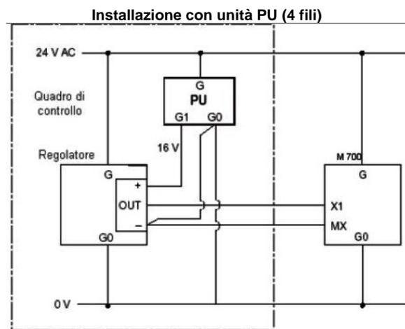
**Segnale modulante, uscita regolatore isolata galvanicamente**
