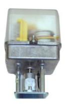
MB15A è un servomotore elettromeccanico per la motorizzazione delle valvole a farfalla modello TRV-S disponibile per alimentazione a 24 V ed è controllato da un segnale 0 – 10 V o 0 – 20 mA. Il campo di rotazione del servomotore è impostato in fabbrica a 90° per adattarsi con TRV-S. MB15A può essere attivato manualmente, un indicatore fra il servomotore e la valvola segnala la posizione della valvola.
