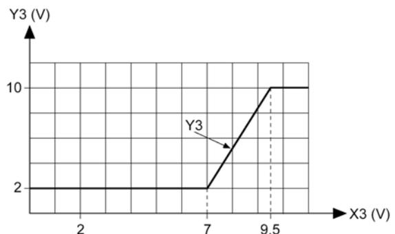
**Conversione di un segnale di controllo configurabile in un segnale 2-10 V con azione diretta o inversa**
