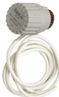
MZ10T è un attuatore termoelettrico progettato per comandare valvole VZ22, VZ32 VZ42 DN15. I servomotori sono usati per valvole da *fancoil*, per valvole da induttori e per valvole di piccoli radiatori. I servomotori operano insieme ai regolatori usando un segnale on/off
