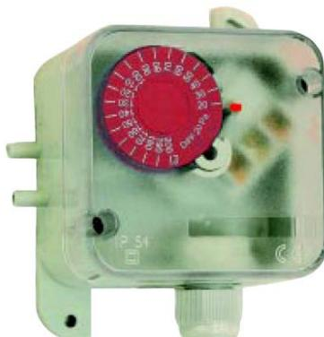
SPD900 è un pressostato differenziale per il controllo della pressione differenziale dell'aria nei canali, filtri e ventilatori. Una manopola di comando con scala graduata permette una facile regolazione. Il presso stato SPD900 è fornito completo di tubo da 2 m e 2 attacchi in plastica. Fluido controllato: aria e gas non aggressivi.
