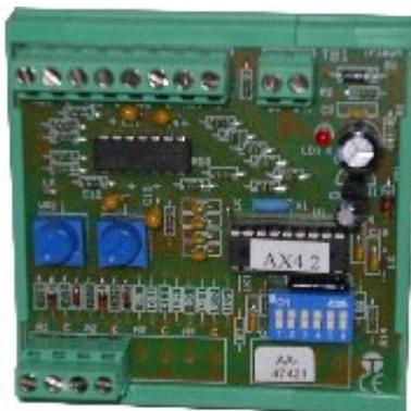
TI-IO/AX4.2 è un modulo di uscita analogico multifunzione che è progettato per convertire 1 o 2 segnali d'ingresso 0-10 V in 2 o 4 uscite analogiche 0-10V. Le due uscite analogiche vengono eseguite in sequenza rispetto al segnale ricevuto con una zona morta tra di loro impostabile da 0 ad 1Volt.
