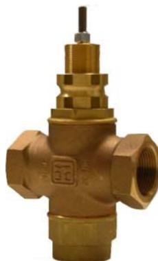
Valvole a 2 e 3 vie a semplice sede per servomotori M310, M400 / M800 usate nei sistemi di riscaldamento e condizionamento. La funzione delle valvole V2GB e V3GB è quella di intervenire sulla portata (riduzione e/o deviazione) o sulla temperatura (miscelazione) del fluido operante al fine di modificare con una azione modulante, l'emissione termica delle unità terminali.
