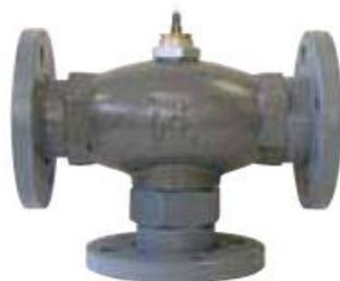
Le valvole V2/3GF possono essere impiegate per la regolazione di fluidi in impianti di condizionamento, refrigerazione e riscaldamento, civili ed industriali. Le valvole a 3 vie devono essere utilizzate esclusivamente come miscelatrici. Non utilizzare mai la via ad angolo per regolazione.
