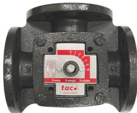
VTRE è una valvola a 3 vie con funzionamento rotativo, studiata per essere utilizzata sia come valvola deviatrice che come miscelatrice. Applicazioni tipiche potrebbero essere riscaldamento, condizionamento e trattamento dell'aria con esigenze moderate per quanto riguarda pressione differenziale e dispersioni.
