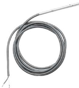
EGLF è studiato per misurare la temperatura dell'aria nei condotti dell'aria su impianti di ventilazione. Il sensore è avvolto con una guaina in PVC. Gli organi di montaggio come la vite e il morsetto sono inclusi nella consegna.
