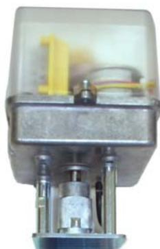
MB15B è un servomotore elettromeccanico per la motorizzazione delle valvole a farfalla modello TRV-S disponibile per alimentazione a 24 V e 230 V ed è controllato da un segnale a tre punti.
