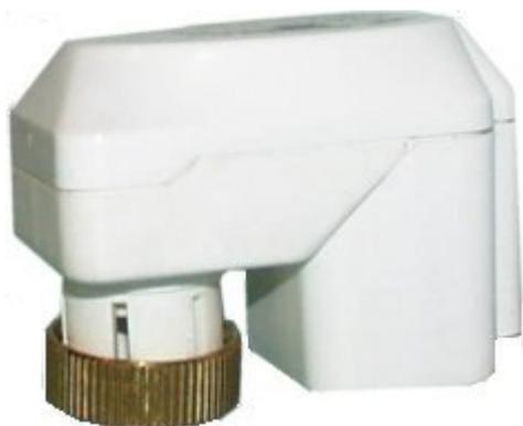
Gli ME3P1/ EMVZ1 sono attuatori elettromeccanici alimentati a 24V e 230V mediante segnale di comando a tre punti o 0-10 V (2-10V). Si distinguono per le ridotte dimensioni d'ingombro e facilità di montaggio; l'accoppiamento dei servocomandi con i corpi valvola non richiede intervento idraulico (svuotamento dell'impianto).
