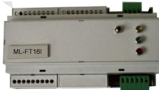
Modulo espansione punti comunicazione per reti Lonworks-FTT10, innesto su barra DIN, alimentazione 24 V DC, con 16 ingressi digitali optoisolati. Firmware per gestione variabili di rete conforme specifiche LonMark.
