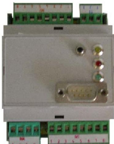
Modulo espansione punti comunicazione per reti Lonworks-FTT10, innesto su barra DIN, alimentazione 24 VDC 100mA, con 4 ingressi digital optoisolati e 4 uscite digitali a relè.
