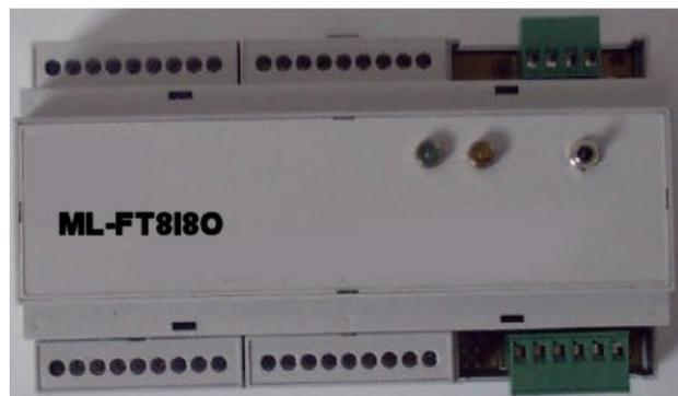
Modulo espansione punti comunicazione per reti Lonworks-FTT10A, innesto su barra DIN, alimentazione 24 V DC 100mA, con 8 ingressi optoisolati 24VDC e 8 uscite a relè.
