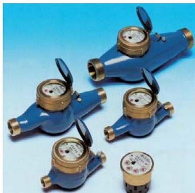
Gli MTRMT sono un contatori a getto multiplo a orologeria asciutta per acqua fredda fino a 50°C. La struttura della camera di misura garantisce un buon lavaggio e previene i depositi, inoltre si aggiunge l'efficace filtro a sacco all'interno del tronchetto di entrata, tra l'altro facilmente sostituibile.
