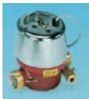
MPWET è un contatore volumetrico a getto unico a turbina con attacchi filettati, ad orologeria asciutta, sottovuoto, orientabile e a lettura diretta con 4-5 rulli numeratori. Le sue caratteristiche ne consentono l'impiego su circuito con acqua calda fino a 120 °C. E' completo di trasmettitore di impulsi reed (K=10L) ed è predisposto per ricevere un sensore di temperatura. Completati di dadi, raccordi e guarnizioni per il montaggio su tubazioni.
