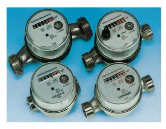
Contatori per acqua fredda max 50°C (MPKEV) e per acqua calda max 90°C (MPWEV) a getto unico con orologeria asciutta a lettura diretta su otto rulli numeratori, orientabile, completo di trasmettitore d'impulsi reèd (k=10 L). Completi dei dadi, raccordi e guarnizioni per montaggio su tubazione.
