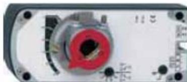
Servomotori con ritorno a molla applicabili su serrande di sicurezza impiegate con funzione antigelo, antifumo o a tenuta nel settore igienico sanitario *on/off* (2 punti). Da applicare su serrande di dimensione massima 1 m<sup>2</sup>. Il servomotore carica la molla di ritorno aprendo la serranda e in mancanza di corrente la molla riporta la serranda in posizione di sicurezza.
