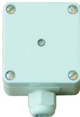
Sonda luminosità per esterno con segnale di tensione 0-10V. La sonda è composta da sensore e convertitore di segnale in un unico contenitore resistente all'azione dei raggi ultravioletti. Il picco sensibile è per luce ad un angolo di incidenza di 0° alla perpendicolare. Il sensore ha lo stesso picco di sensibilità di spettro dell'occhio umano. Il convertitore è collegato a 2 fili e funziona sia da alimentatore che da segnale di trasmissione.
