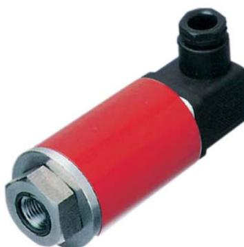
Il trasmettitore di pressione della serie SP-G è adatto per l'utilizzo con aria, gas non corrosivi, vapore a bassa pressione, acqua calda (con guarnizione FPM), freon e ammoniacca (con guarnizione CR). Il trasmettitore è costruito intorno ad un sensore ceramico e un amplificatore di segnale con uscita in tensione 0-10 V DC, l'attacco di serie è G 1/4 interno. Sono disponibili diversi modelli con differenti scale di pressione e tipi di connettore.
