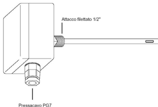
La sonda STC-130 e' prevista per sentire la temperatura dell'aria in canali tramite un tubetto metallico alla cui estremità e' posizionato il sensore. I collegamenti elettrici sono effettuati all'interno di una scatola plastica dalla quale esce un pressacavo tipo PG7. Il sensore e' di tipo PTC.
