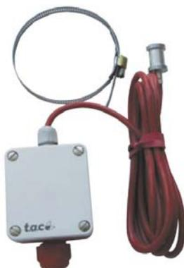
Sonda di temperatura a contatto attiva per tubazioni con conversione del valore di temperatura misurato in un segnale di corrente 4-20mA. La sonda è composta da sensore, collare per tubazione fino a DN100 massimo, cavo di collegamento lungo 2000 mm e convertitore di segnale.
