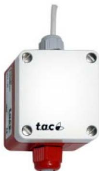
STD190 contiene quattro termistori ed è un sensore di temperatura di valore medio. Il sensore è utilizzato per misurare la temperatura nei condotti d'aria. Viene montata sopra ad una griglia o su collegamenti sospesi attraverso un condotto.
