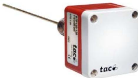
STP120 è una sonda di temperatura per acqua ad immersione senza pozzetto, studiata per il montaggio sulla tubazione e fornita in tre versioni con diverse lunghezze in funzione del diametro di tubazione utilizzato. L'elemento sensibile in guaina d'acciaio (NTC1.8 kohm) viene immerso nella tubazione; filettatura 1/2" maschio (DN15).
