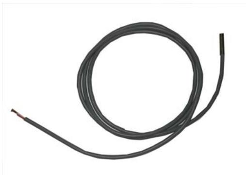
La sonda STW-B25 è un sensore previsto per il montaggio in aria o in liquidi (tramite pozzetto GW-33 non incluso) dotato di cavo in silicone bipolare di lunghezza totale L=150 cm. Il sensore è dotato all'estremità sensibile di un tubetto in ottone nichelato di 6x25 mm. Il sensore è di tipo PTC da 2.026 ohm @ 25°C (vedi valori esatti in tab.). I terminali sono spellati e stagnati.
