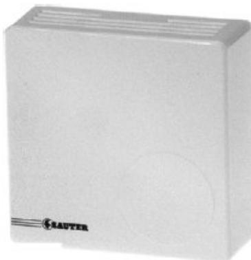
SU32 A è un trasmettitore di umidità relativa ambiente con un segnale di uscita 0(2)-10V o 0 (4)-20mA. L'umidità relativa è registrata con un sensore capacitivo e veloce ed è convertita da un amplificatore di misura nel segnale standard 0-10V. l'uscita può essere modificata a 2-10 V. quando il carico è <math><500\Omega</math>, l'uscita passa automaticamente ad un segnale corrente di 0 a 20 mA (o 4 a 20 mA)
