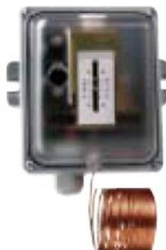
Termostato di protezione antigelo per scambiatori di calore e riscaldatori elettrici per impianti di condizionamento e refrigerazione. Segnalazione con controllo di temperatura inferiore ad un valore di guardia prestabilito. Autoprotezione per guasto dell'elemento sensibile.
