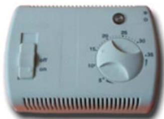
TFA1V-BM è un termostato elettronico per la regolazione della temperatura ambiente in impianti di condizionamento dell'aria con ventilconvettori da installare a bordo macchina, dotato di inserzione automatica di velocità del ventilatore, commutazione automatica del riscaldamento/raffrescamento e controllo di una valvola.
