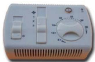
TFMVR-P/BM è un termostato elettronico per la regolazione della temperatura ambiente in impianti di condizionamento dell'aria con ventilconvettori dotato di selettore manuale velocità, interruttore acceso/spento, controllo temperatura di tipo on/off, comando remoto funzione estate/inverno, controllo di una valvola. TFMVR-P/BM ha le seguenti caratteristiche principali:
