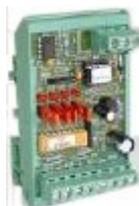
Il TI-IO/DIM4 è un modulo multiplexer che converte 4 ingressi digitali in 1 uscita analogica. Ogni combinazione degli stati degli ingressi digitali viene convertita in un valore sull'uscita analogica, questa può essere utilizzata con un regolatore in grado di interpretare i vari livelli di segnale riconvertendoli negli effettivi stati dei 4 ingressi.
