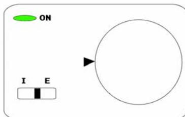
Termostato elettronico per fancoil 3 velocità, con sonda aria interna ed interruttore per commutazione inverno/estate. Il funzionamento è indicato da un LED bicolore (verde/estate, rosso/inverno). E' possibile installare un termostato di minima esterno.
