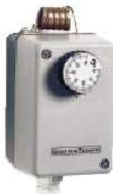
Termostato con elemento sensibile a spirale esterno al contenitore per applicazione di tipo industriale. Realizzato in contenitore stagno può essere installato in ambienti a forte inquinazione (polverosi e umidi) per il controllo della temperatura. Tipiche applicazioni in magazzini, serre, capannoni industriali, centri sportivi ecc. Il bulbo sensibile è in rame a riempimento di liquido. Il microinterruttore è stagno alla polvere con contatto in commutazione (caldo/freddo).
