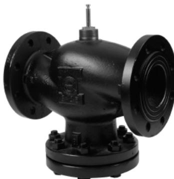
Le valvole flangiate V2/V3FF possono essere utilizzate con funzioni di regolazione di portata (riduzione o deviazione) o sulla temperatura del fluido (miscelazione) negli impianti di climatizzazione con acqua calda e refrigerata. Largamente utilizzate soprattutto in grandi impianti, sono motorizzabili con i servomotori M24-25, EM 24-25, M24-10, EM24-10.
