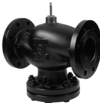
Le valvole flangiate V2/V3GHF possono essere utilizzate con funzioni di regolazione di portata (riduzione o deviazione) o sulla temperatura del fluido (miscelazione) negli impianti di climatizzazione con acqua calda o refrigerata. Largamente utilizzate soprattutto in grandi impianti, sono motorizzabili con i servomotori MH24-10, EMH24-10, MHF24-25, EMHF 24-25, MHF24-40, EMHF 24-40
