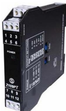
Strumento con separazione galvanica impiegato per la conversione di un segnale di temperatura da termoresistenza PT100 in un segnale standard V-mA. Lo strumento ha una separazione galvanica a tre punti tra ingresso, uscita e alimentazione con isolamento 1.500 V AC, può quindi essere installato anche a notevole distanza (qualche centinaio di metri) dalla termoresistenza senza per questo correre il rischio
