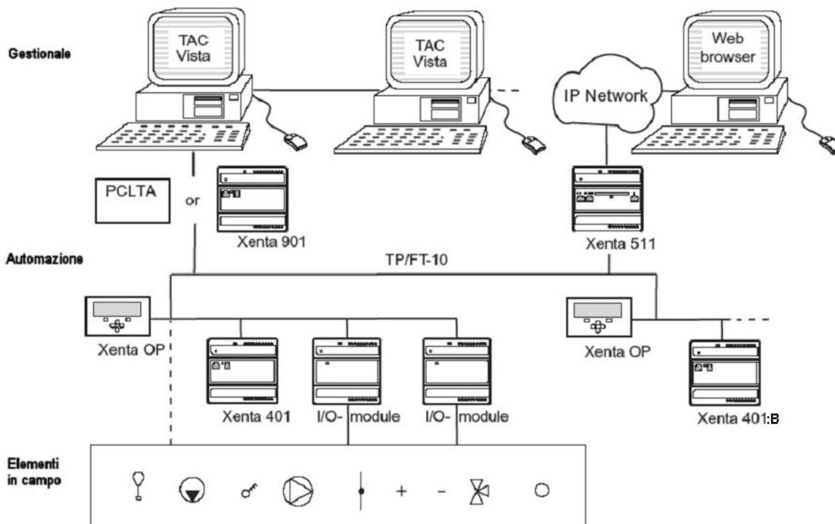
La figura mostra un esempio di configurazione in *network* dello XENTA. I sensori e gli attuatori installati in campo sono collegati agli ingressi ed alle uscite dei regolatori e dei moduli di espansione punti.
