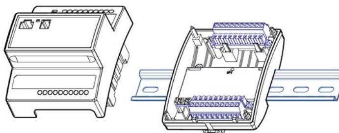
Tutti i collegamenti vengono effettuati soltanto sulla morsettiere, questo permette la sostituzione della scheda elettronica non funzionante senza dover effettuare di nuovo il cablaggio dell'apparecchiatura.
