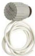
Attuatore termoelettrico progettato per comandare valvole VZ22, VZ32 VZ42 DN15. per unità terminali (*fancoil*, induttori e radiatori). Disponibile con alimentazione a 24 V AC o 230 V AC
