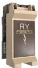
Unità ausiliaria utile per convertire un segnale 2-10 V DC in un comando *on-off*. Il relè può essere eccitato, a scelta, con aumento di segnale (funzione estiva) o con diminuzione di segnale (funzione invernale). Il valore della tensione di eccitazione ed il differenziale tra eccitazione e diseccitazione sono impostabili singolarmente. Il relè ha un ritardo fisso di 3 secondi sia all'atto dell'inserzione sia a quello della disinserzione. Il modulo RY1 ha un contatto SPDT (in commutazione).
