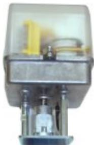
Disponibile per alimentazione a 24 V e 230 V MB15B è controllato da un segnale increase/decrease a 3 punti. Il campo di rotazione dell'attuatore è impostato in fabbrica a 90° per adattarsi con TRV-S. Un indicatore fra l'attuatore e la valvola segnala la posizione della valvola.
