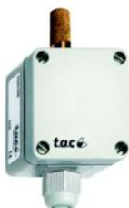
SHO100 è una sonda elettronica che misura l'umidità relativa (RH) e converte il valore misurato in un segnale di corrente 4–20 mA o di tensione 0–10 V. La sonda è composta da un sensore montato in un involucro in alluminio e da un convertitore di segnale montato in una custodia a parte.
