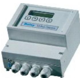
Ideale per gli impianti M-Bus fino a 60 nodi. Il modello base è il Convertitore di Livello M-Bus che è equipaggiato con le interfacce RS232 e RS485 e display LCD che consente tutte le operazioni in tempo reale. È possibile effettuare le letture di tutti i parametri con pochi comandi dalla tastiera e trasferire i dati direttamente a un PC o in remoto via modem.
