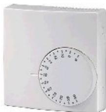
RER-30 è un regolatore con azione P.I. impostabile della temperatura ambiente. La tensione di uscita è 0-10V con azione inversa e cioè all'aumentare della temperatura si ha un decremento del segnale in uscita. È dotato di sensore interno o in alternativa può ricevere una sonda remota posta in ambiente (STR-050) oppure sul canale aria (STC130). Possibilità di riduzione della temperatura impostata su manopola con selezione o orologio esterno (riduzione notturna).
