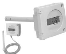
• Trasmettitore di velocità e di temperatura modello SVA100 • Scale da 0-5 m/s a 0-30 m/s e 0 a +50°C, -20 a +80°C, -50 a +50°C, 0 a +100°C (vedi "Configurazione") • Uscita 0-10 V o 4-20 mA, attivo, alimentazione 24 Vac/Vdc (3-4 fili) • Contenitore ABS IP 65 con o senza display • Visualizzazione alternata della velocità e della temperatura • Installazione 1/4 di giro su placchetta di fissaggio a parete
