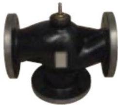
Le valvole della serie V2/V3FF1 sono impiegate per la regolazione o l'intercettazione di fluidi in impianti di riscaldamento, raffreddamento, ventilazione, sistemi di condizionamento aria in impianti civili e industriali. Le valvole a 3 vie sono utilizzate come miscelatrici, possono essere utilizzate come deviatrici riducendo del 50% i valori di targa della pressione differenziale massima
