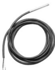
È una sonda ad immersione appositamente studiata per essere installata all'interno dei pozzetti, nelle regolazioni di impianti di riscaldamento. Il sensore in acciaio inox è fornito completo di cavo da 2 o 4 m con guaina esterna in PVC.
