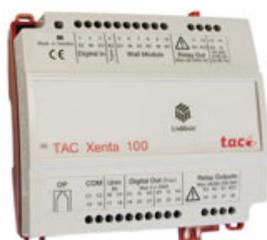
Controllore DDC configurabile, certificato LonMark®, per unità terminali VAV con ventilatore elettrico e controllo On/Off. Consente la gestione di un post riscaldatore elettrico. Può essere utilizzato come unità stand-alone o integrato in reti LonWorks® Vista®. Supporta i moduli STR ed il pannello Xenta OP per il controllo dei setpoint e delle variabili d'ambiente.
