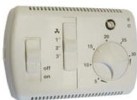
Selettori leva on/off, comando delle 3 velocità ventilatore, estate / inverno. Comando valvola motorizzata. Possibilità di collegamento sonda temperatura acqua SWF-TFM per funzionalità termostato di minima invernale.
