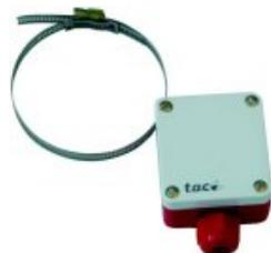
È studiata per il montaggio direttamente sulla tubazione (max. Ø 100 mm). Per assicurare una conduzione termica ottimale alla piastra di contatto e quindi al termistore dell' STC100 / 101, la sonda deve essere montata su un tratto di tubazione non isolata. Il contenitore della sonda STC100 è provvisto di un pressacavo Pg11. Il contenitore della sonda STC101 presenta un foro di Ø 20 mm per il passaggio del cavo.
