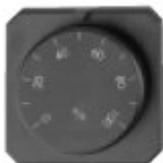
Appositamente studiati con accessori per montaggio a parete, o da retroquadro, i trasduttori di posizione PCS P/F forniscono un segnale di posizione per attuatori per serrande (EMS e EMSR) a controllo modulante, tale segnale sarà proporzionale alla posizione della manopola da 0 a 100%. Può ricevere un segnale esterno 0(2)-10 V che sarà paragonato con quello dall'impostazione della manopola. Il segnale più alto passerà sull'uscita di comando per l'attuatore.
