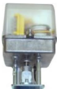
Disponibile per alimentazione a 24 V, controllato da un segnale 0-10 V o 0 - 20 mA. il campo di rotazione del attuatore è impostato in fabbrica a 90° per adattarsi con TRV-S. Un indicatore fra l'attuatore e la valvola segnala la posizione della valvola.
