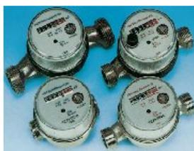
Orologeria asciutta a lettura diretta su otto rulli numeratori, orientabile, completo di trasmettitore d'impulsi reed (k=10 L). Completi di dadi, raccordi e guarnizioni per il montaggio su tubazioni
