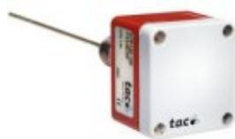
È una sonda di temperatura per acqua ad immersione senza pozzetto, studiata per il montaggio diretto sulla tubazione e fornita in tre versioni con diverse lunghezze in funzione del diametro di tubazione utilizzato. L'elemento sensibile è guaina d'acciaio inox (Ø 3 mm), l'attacco è ½ maschio.
