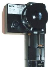
M700 è un attuatore elettromeccanico con ritorno a molla per il controllo di valvole a due e tre vie adatto all'utilizzo in sistemi di riscaldamento, trattamento dell'aria o acqua calda domestica. Può essere controllato sia da una segnale ad impulsi che da uno modulante tra 2 - 10V.
