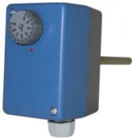
Con elemento sensibile incapsulato in guaina protettiva in ottone con testa esagonale 1/2"G. Adatto per applicazioni di tipo industriale, per il controllo della temperatura di liquidi non corrosivi. Realizzato in contenitore stagno, è particolarmente indicato per l'installazione in ambienti a forte inquinazione (polverosi e umidi).
