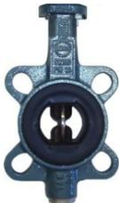
E' progettata per regolazione continua di acqua, aria, e vapore a bassa pressione fino a max. 110°C per essere inserita tra due controflange di tipo PN6, PN10 o PN16. La chiusura ermetica è assicurata da un rivestimento di gomma di etil-propilenica. Lo speciale rivestimento del corpo elimina l'esigenza delle guarnizioni della flangia. Il modello del servomotore da prevedere sulla valvola è determinato dal tipo di sistema di controllo, dalla forza del servomotore, dal tempo di rotazione ecc.
