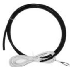
È una sonda per interrimento in polietilene avente un diametro di Ø 3/8", la sonda è costituita essenzialmente da quattro termistori, posizionati uniformemente sulla lunghezza del tubo. Il sensore è prolungato con un cavo di 2 m. Per il passaggio del cavo deve essere predisposto una tubazione del diametro di Ø12mm.
