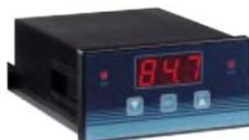
Il regolatore digitale serie RDL-20A-10K, è stato realizzato principalmente per l'utilizzo in unità trattamento aria (UTA). Munito di 2 uscite proporzionali 0...10V, una per riscaldamento ed una per raffreddamento consente la regolazione sia estiva che invernale.
