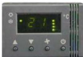
Regolatore elettronico per fan-coil 2 tubi, con o senza valvola e 4 tubi. Controllo automatico delle 3 velocità ventilatore e valvola/e. Scheda base di potenza e modulo di comando con display LCD e tasti funzionali. Possibilità di impostazioni bloccaggio tastiera, cambio stagione manuale o automatico tramite sonda acqua (SW-REFC), ciclo destratificazione dell'aria, correzione sonda aria. Alimentazione 230Vac - 50 Hz
