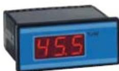
Visualizzazione dell'umidità relativa trasdotta da trasmettitori di umidità con uscita in corrente (4...20 mA a 2 o 3 fili). I trasmettitori possono essere alimentati direttamente dall'apparecchio se ammettono una tensione da 13.5 a 25 Vcc non regolata. Gestione di allarmi di tipo ottico (display lampeggiante e visualizzazione di codici di errore) in caso di trasmettitore aperto o in corto circuito.
