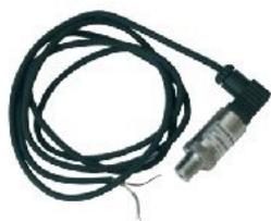
I trasmettitori di pressione SPP110 sono adatti all'utilizzo in sistemi HVAC per monitorare la pressione. SPP110 è un trasmettitore che converte la pressione misurata in un segnale elettrico 0-10 V. SPP110 è fornito completo di cavo di 2 m (6.6 ft) e di un adattatore G1/2. Fluido controllato: qualsiasi fluido compatibile con l'acciaio inox.
