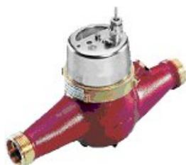
Con orologeria asciutta, sottovuoto, orientabile, a lettura diretta su 5 rulli numeratori, completa di trasmettitore d'impulsi reed (K=2.5/10 L-Standard K=10L). Istallazione verticale/orizzontale o solo verticale. Completati di dadi, raccordi e guarnizioni per il montaggio su tubazioni
