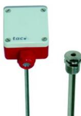
Adatta al montaggio su tubazione, con l'ausilio del pozzetto in acciaio inossidabile o in ottone PN16, così, in caso di necessità, sostituzione del sensore è facile e rapida. STP100 è il modello completo di pressacavo Pg11, mentre STP101 presenta un foro di ingresso cavo con Ø 20 millimetri.
