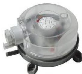
Controlla la pressione di filtri, ventilatori, canali d'aria, impianti di condizionamento e ventilazione. PDA-205 viene installato in ambienti con aria e gas non corrosivi e non infiammabili ed è particolarmente indicato per il controllo e la sicurezza negli impianti di condizionamento, per la segnalazione d'arresto di ventilatori ed intasamento filtri.
