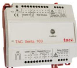
Controllore DDC configurabile, certificato LonMark®, per unità terminali VAV con controllo On/Off ventilatore e riscaldamento a valvola. Può essere utilizzato come unità stand-alone o intergrato in reti LonWorks® Vista®. Supporta i moduli STR ed il pannello Xenta OP per il controllo dei setpoint e delle variabili d'ambiente.
