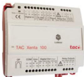
Controllo integrato della temperatura ambiente mediante pannello multifunzione della serie STR e controllo illuminazione per 2 zone. 6 differenti programmi operativi (regime normale/ridotto e boost). Presa jack per la connessione con terminale portatile XENTA OP. Porta di comunicazione TP/FT-10 per rete con protocollo standard LonWorks®.
