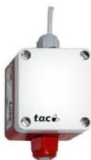
STD190 contiene quattro termistori ed è una sonda di temperatura di valore medio utilizzato per misurare la temperatura nei grandi condotti d'aria. Viene montata sopra ad una griglia o su collegamenti sospesi attraverso un condotto. Il sensore è composto da un box di connessione con amplificatore di segnale con quattro sensori su un cavo a intervalli di 1 metro l'uno dall'altro per un totale di 3 metri.
