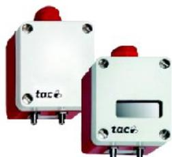
I trasmettitori elettronici SPD110 / SPD160 convertono la pressione differenziale misurata in un segnale elettrico 0-10 V. Il modello SPD160 integra un display LCD per la visualizzazione del valore della pressione in Pa. SPD110 / SPD160 sono forniti completi di tubo da 2 m e 2 attacchi per canale in plastica. Fluido controllato: aria e gas non aggressivi.
