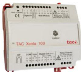
Controllore DDC configurabile, certificato LonMark®, per unità terminali VAV con uno o due stadi di riscaldamento. Integra una sonda velocità dell'aria. Può essere utilizzato come unità stand-alone o intergrato in reti LonWorks® Vista®. Supporta i moduli STR ed il pannello Xenta OP per il controllo dei setpoint e delle variabili d'ambiente.
