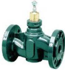
Può essere utilizzata per sistemi di riscaldamento, condizionamento, trattamento aria e acqua sanitaria e con i seguenti fluidi: · acqua calda e fredda · acqua contenente additivi come fosfati acqua con additivi antigelo come glicole. Per applicazioni con temperature del fluido inferiori a 0°C prevedere il relativo riscaldatore.
