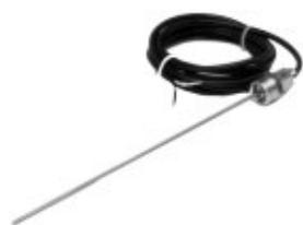
È una sonda ad immersione studiata per essere installata all'interno dei tubi che presentano una tasca apposita per la misurazione della temperatura dell'acqua. L'elemento sensibile è in acciaio inossidabile. Il sensore è equipaggiato con un cavo di 2m e con due filettature. Una con DN8 maschio e l'altra con DN15 maschio per permettere la riduzione della boccola.
