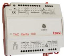
Preconfigurato per unità terminali fancoil, con controllo delle tre velocità certificato LonMark®, permette di gestire un singolo fancoil a 2 tubi con o senza valvola o 4 tubi con valvola. 6 differenti programmi operativi (regime normale/ridotto e boost). Presa jack per la connessione con terminale portatile XENTA OP.
