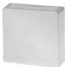
È un trasmettitore di umidità relativa ambiente con un segnale di uscita 0(2)-10V o 0 (4)-20mA. L'umidità relativa è registrata con un sensore capacitivo e veloce ed è convertita da un amplificatore di misura nel segnale standard 0-10V. l'uscita può essere modificata a 2-10 V. quando il carico è  $< 500\Omega$ , l'uscita passa automaticamente ad un segnale corrente di 0 a 20 mA (o 4 a 20 mA)
