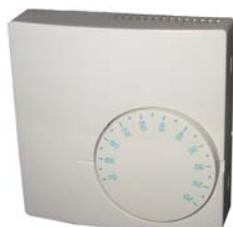
Regolatore elettronico per il controllo della temperatura dell'acqua di tipo PI, con tempi di integrazione selezionabili. L'uscita è 0-10 V con azione inversa. I sensori remoti compatibili sono STW-GP 120 e STW-B25. Possibilità di riduzione della temperatura impostata sulla manopola con selettore o orologio esterno (riduzione notturna).
